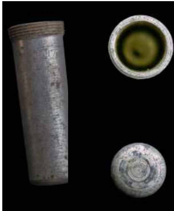
▲ Dimensions : largeur 28/29 mm au niveau du filetage ; longueur totale 84 mm. Rappelons que l'obus est une munition creuse perforante qui enferme la charge explosive.
