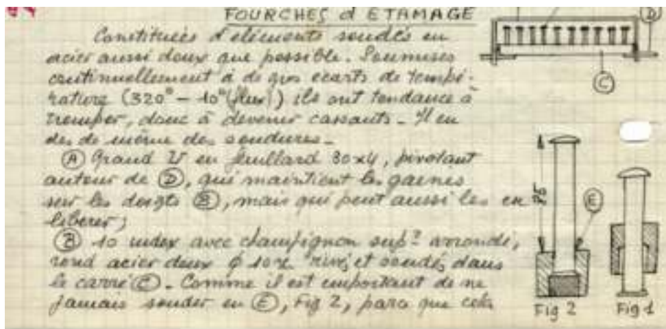
▲ Extraits du cahier de G. Rodolausse décrivant le processus de fabrication des gaines d'obus : ici la description des « râteaux » servant à immerger les gaines dans le bain de traitement.
