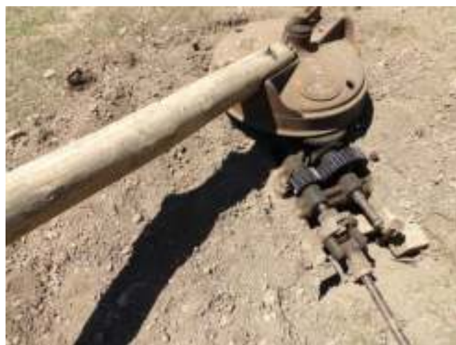
▲ Fête des battages à Saint-Antonin en 2015 : détail d'un manège à chevaux pour actionner les machines agricoles (fabricant Simon Frères à Cherbourg). Ce système permet de travailler sans avoir de locomobile.
